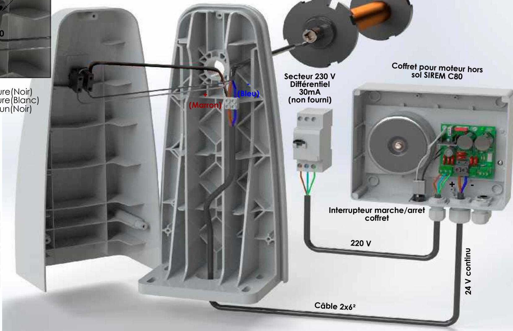
Contact sec pour piloter l'électrolyseur.
